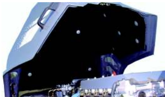
Revêtement insonorisant d'un capot moteur
